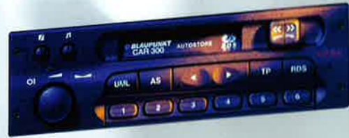
„Blaupunkt CAR 300“ mit 4 x 7 Watt Ausgangs- leistung, Radio-Cassetten-Gerät mit Klangregelung und Diebstahlsicherung.
