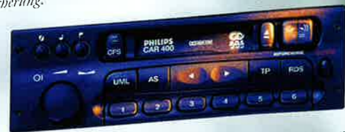
„Philips CAR 400“: abnehmbares Bedienteil, integriertes Cassettedeck, Dolby „B“, Auto- reverse, Telefonvorbereitung (Sonderausstattung).
