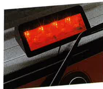
Mehr Licht beim Bremsen. Die dritte Bremsleuchte fürs Heckfenster warnt durch ihre Strahlkraft frühzeitig die nachfolgenden Autofahrer.
