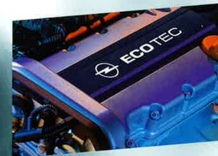
Jüngstes Mitglied in der ECOTEC-Motorenfamilie ist der 1.2 16V-Motor mit 48 kW/65 PS.
