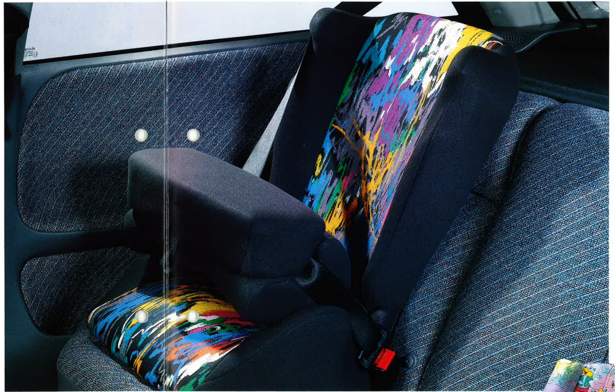
Kindersicherheitsystem. Darin finden Kinder von 10 Monaten bis 12 Jahren sicheren und bequemen Halt. Es besteht aus Sitzschale, Rückenlehne und Tisch, die nach dem Baukastenprinzip zusammengesetzt sind. Mit zunehmender Größe des Kindes werden die zu klein gewordenen Teile einfach abgenommen. Das Kindersicherheitsystem paßt für alle Opel Modelle.
