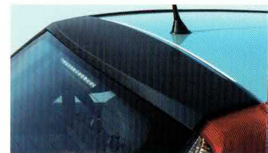
Der dezente Heckspoiler verbessert die Aerodynamik des Corsa Sport, ohne aufdringlich zu wirken.
