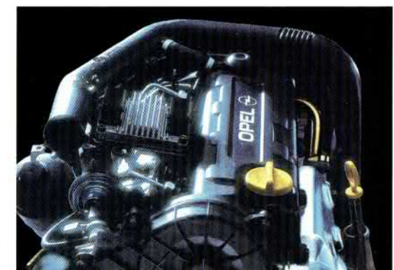
Überrascht durch seine eindrucksvolle Leistungsentfaltung und seinen geringen Verbrauch: der 1.7 DTI Turbodiesel-Motor mit Direkteinspritzung und 55 kW (75 PS).
