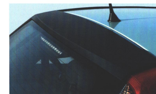
Der dezente Heckspoiler verbessert die Aerodynamik des Corsa Sport, ohne aufdringlich zu wirken.
