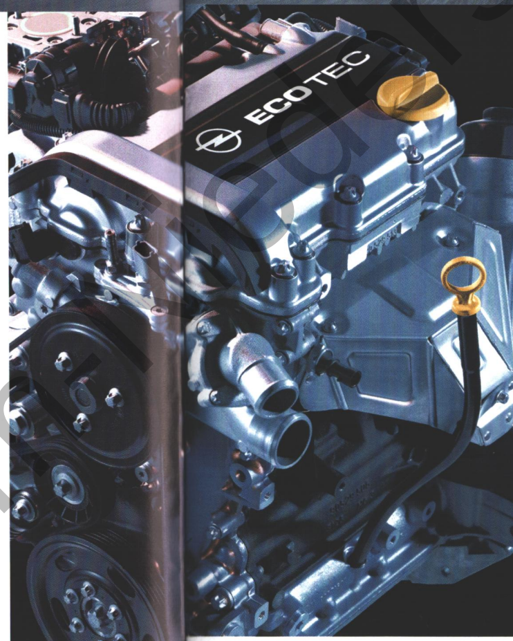
Der 1.0 12V ECOTEC®-Motor mit 43 kW (58 PS) erfüllt bereits die Euro 4-Norm und reduziert damit nicht nur die Schadstoffemissionen, sondern auch die Steuerlast.
