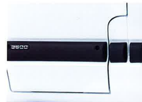
Die breiten Seitenschutzleisten sorgen dafür, daß kleinere Remppler ohne größere Folgen bleiben. Bei Beschädigung sind sie leicht auszuwechseln.
