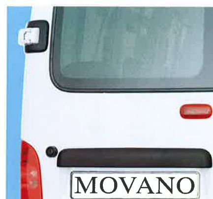
Ein Warnsignal mehr. Die 3. Bremsleuchte an der Hecktür des Opel Movano.
