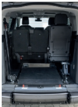
Der Umklappmechanismus der EasyFlex 1 Rampe ermöglicht eine uneingeschränkte Nutzung des Kofferraums.
