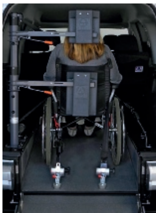
Die Kopf- und Rückenstütze FutureSafe 1 für den Rollstuhlinnassen.
