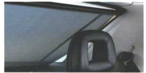
Der ausziehbare Sonnenschutz für die Heckscheibe ist in die hintere Ablage integriert. Elektrische Bedienung vom Fahrersitz aus.
