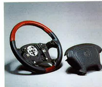
auf höchstem Niveau. Die Weiterverwendung des Original-Airbags garantiert 100%ige Zuverlässigkeit, da keine sicherheitsrelevanten Teile ausgetauscht werden, sondern lediglich der serienmäßige Lenkradkranz.
