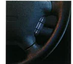
Radiofernbedienung im Lenkrad ab Philips CAR 400. Bei der Sendereinstellung, Cassetten- bzw. CD-Wahl und Lautstärkenregelung bleiben beide Hände am Steuer.
