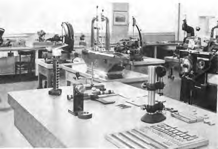
TEILANSICHT des Meßraumes. Im Vordergrund eine Meßplatte aus Granit mit einer Ebenheit innerhalb von fünftausendstel Millimeter; im Hintergrund Prüfgeräte für die Messung an Verzahnungen
