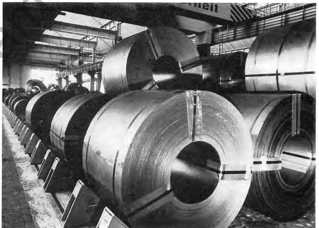
Dieses Bild zeigt einen Teil des Materiallagers. Das „Ringmaterial“ wiegt bis zu 15 t.
