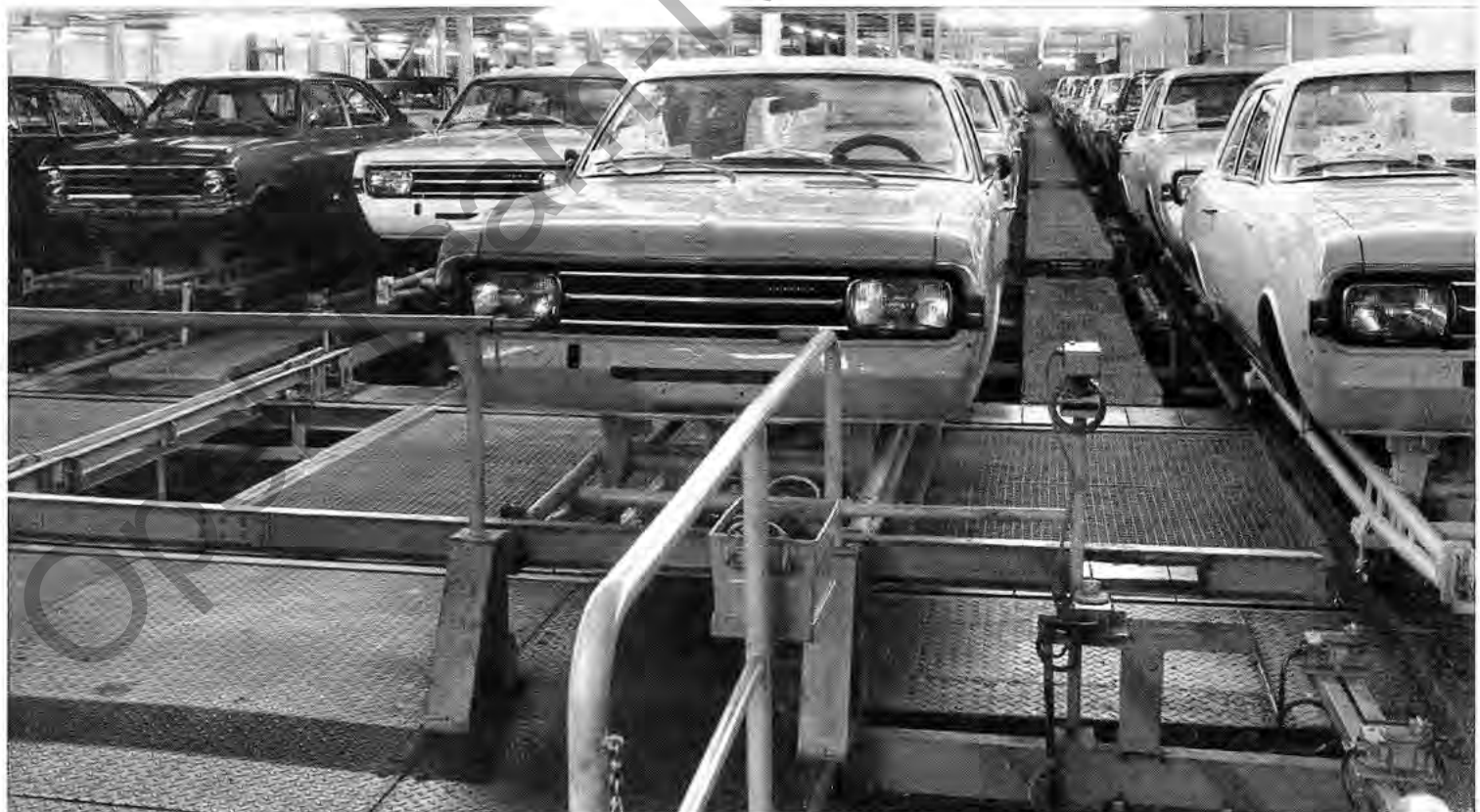
Der automatische Karosseriespeicher faßt 340 Karosserien in zwei Bahngruppen, die sich auf vier Stockwerke verteilen. Ein elektronischer Rechner steuert sie entweder in das Fertigmontageband oder das Endmontageband ein, denen über andere Bänder die noch fehlenden Aggregate zur endgültigen Montage zugeführt werden. Der Stapel ist einer der modernsten seiner Art in Europa.
