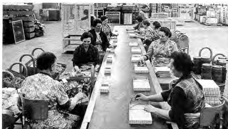
Unter flinken Frauenhänden entstehen an Bändern sogenannte Reparatur-Packungen – eine Zusammenstellung der für eine bestimmte Reparatur benötigten Teile.
