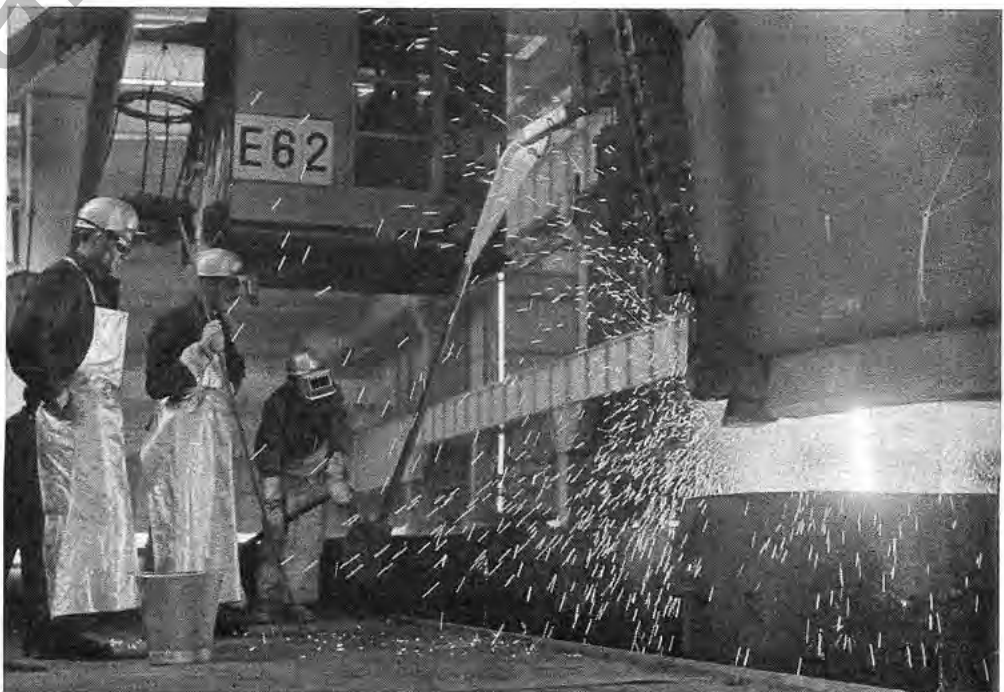
Abgießen von Rohstahl in Kokillen im Oxygen-Stahlwerk.
