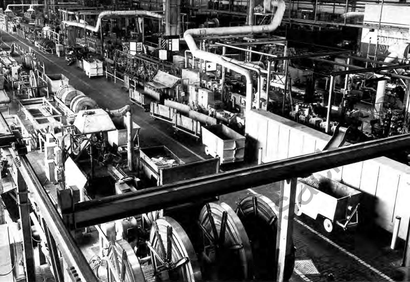
Blick in das Rüsselsheimer Rohrwalzwerk im K-48. Links im Vordergrund 4 Haspeln mit vorbereitetem Bandmaterial. Eine Haspel faßt ca. 3.000 Meter Rollenband.
