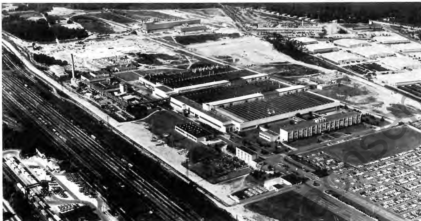
Luftaufnahme unseres Werkes Kaiserslautern, das Teile für die Werke Rüsselsheim und Bochum herstellt, unter anderem Gelenkwellen, Stoßdämpfer, Kupplungsteile, Lenkungen, Bremszylinder, Automatenteile, Wasserpumpen, Kunststoffteile, Sitzrahmen sowie Preß- und Stanzteile. Gesamtfläche des Werksgebietes: 1,5 Millionen qm. (Vom Regierungspräsidenten zur Veröffentlichung freigegeben.)
