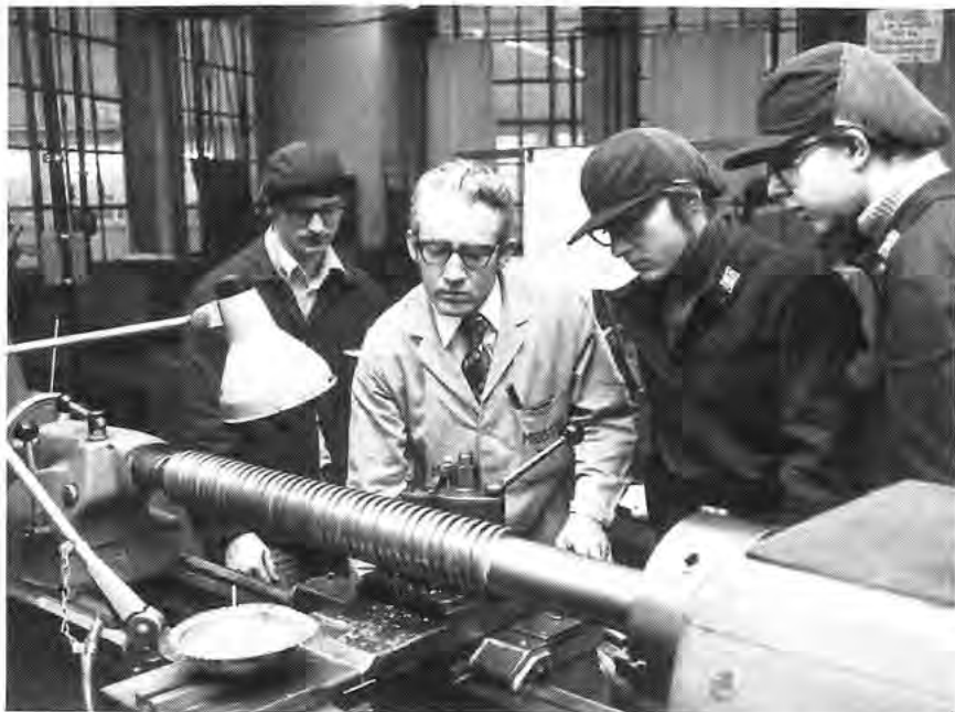
Unterweisung an der Drehmaschine beim Gewindeschneiden einer dreigängigen Spindel mit Meister H. Caps und (von links) den Auszubildenden Th. Schmidt, H. Ogarek und G. Knusmann.
