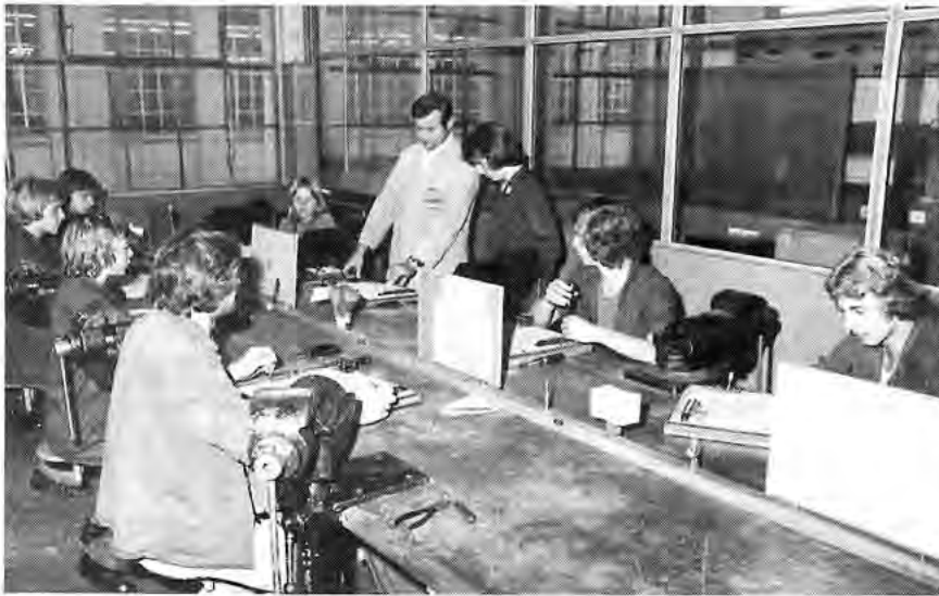
Auszubildende Elektroanlagen-Installateure bei der Montage einer elektrotechnischen Schaltung nach Bauschaltplan. Die Funktion wird nach Fertigstellung von Meister R. Gerhardt geprüft.
