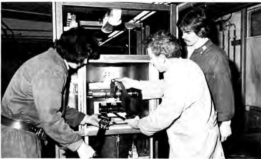
Die in der Rüsselsheimer Lehrwerkstatt gemachten Aufnahmen zeigen Auszubildende des dritten Ausbildungsjahres: Dieser Sicherheitsgurt-Prüfstand wurde in der Lehrwerkstatt gebaut. Die Auszubildenden M. Dapper (links) und H. Stahl mit Meister E. Ewald (Mitte) prüfen gerade den automatischen Gurtaufroller.
