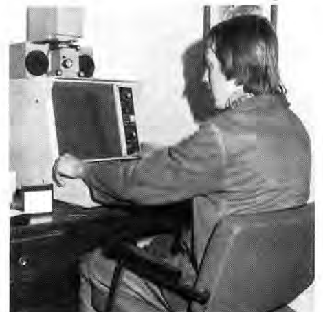
Nach dem Entwickeln muß jeder Film zunächst geprüft werden. Diese Aufgabe ist hier Mitarbeiter R. Müller am Mikrofilm-Lesegerät übertragen.
