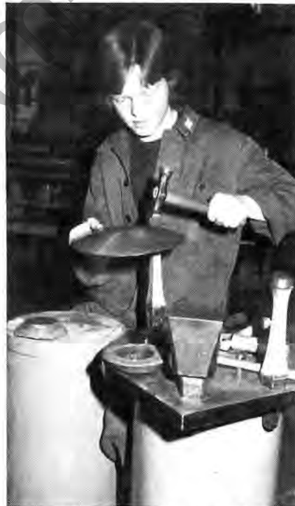
F.-J. Jilg ist auszubildender Feinblechner im zweiten Ausbildungsjahr. Unser Foto zeigt ihn bei einer Treibarbeit mit dem Kugelhammer.
