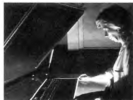
Mitarbeiterin Elfriede Faust an einem elektronischen Printer. Rund 400 Vergrößerungen 18 x 24 cm werden mit Hilfe dieses Gerätes in 40 Minuten automatisch belichtet (links). — Rechts Mitarbeiterin Gustel Luh am Kopiergerät bei der Herstellung von Schwarzweiß-Kopien.
