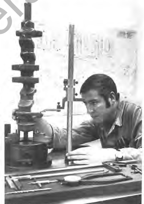
Maß-Kontrolle des Bleimodells. „Anreißen“ nennt das der Fachmann. Bei dieser Tätigkeit Mitarbeiter P. Bingel.
