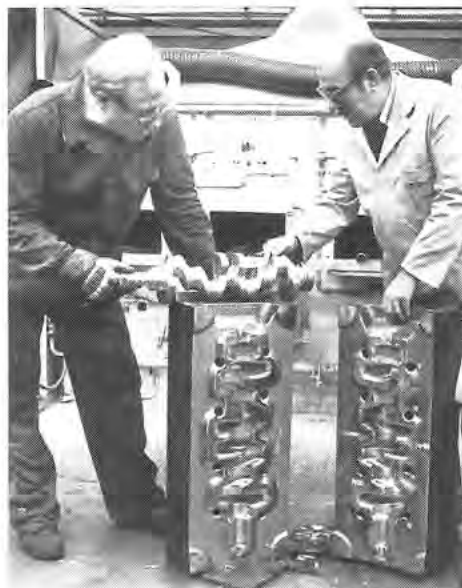
Maß-Kontrolle des Bleimodells. „Anreißen“ nennt das der Fachmann. Bei dieser Tätigkeit Mitarbeiter P. Bingel.
