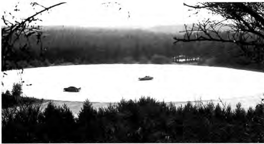
Das Skid-Pad, die Schleuderfläche des Prüffeldes, hat 100 m Durchmesser und dient unter anderem für Überneigungsmessungen, Schlupfwinkelmessungen und Geräuschverhalten der Fahrzeuge.
