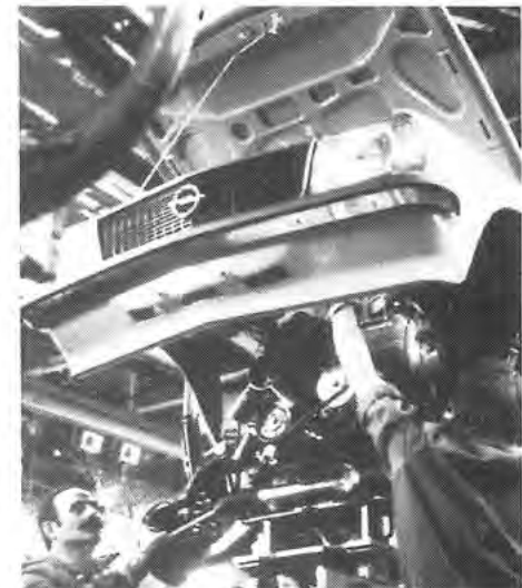
LINKS: Einige Stationen weiter: Scheinwerfermontage. – MITTE: Wieder ein paar Schritte weiter in der Fertigungsmontage: Einsetzen des Kühlergitters. – RECHTS: Und hier sind wir schon in der ersten Phase der Endmontage: Auf dem Bodenförderer nähern sich Motor, Getriebe und Achsen. Die fertig ausgestattete Karosserie senkt sich gerade auf diese Aggregate herab und wird mit ihnen verbunden: „Hochzeit“ nennt man das im Betriebsmund.
