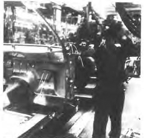
Eine der vielen Schweißoperationen zur Fertigstellung des stählernen Kleides.
