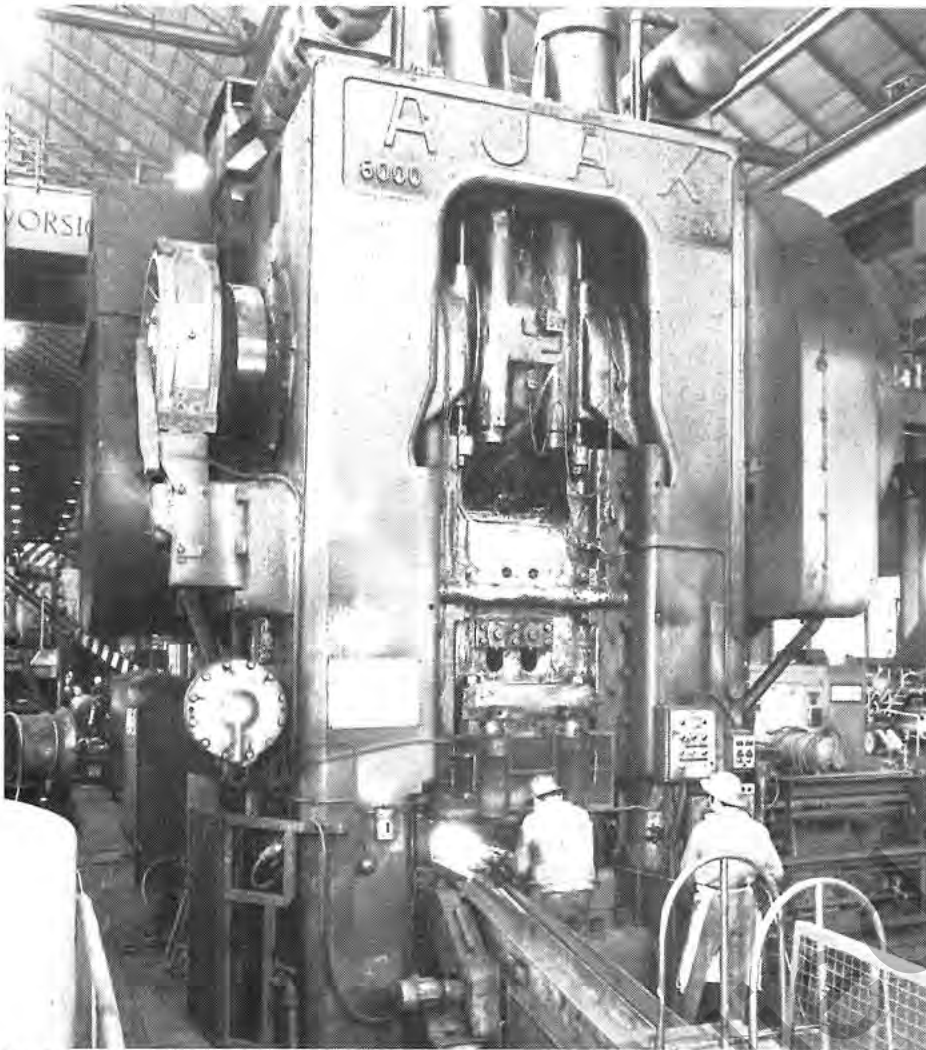
Doch bis es soweit war, daß die Arbeiten an der Endmontage beginnen konnten, mußten in anderen Werkbereichen wichtige Teile produziert werden, beispielsweise in der Schmiede auf dieser 6.000 Tonnen-Ajax-Schmiedepresse eine Kurbelwelle.
