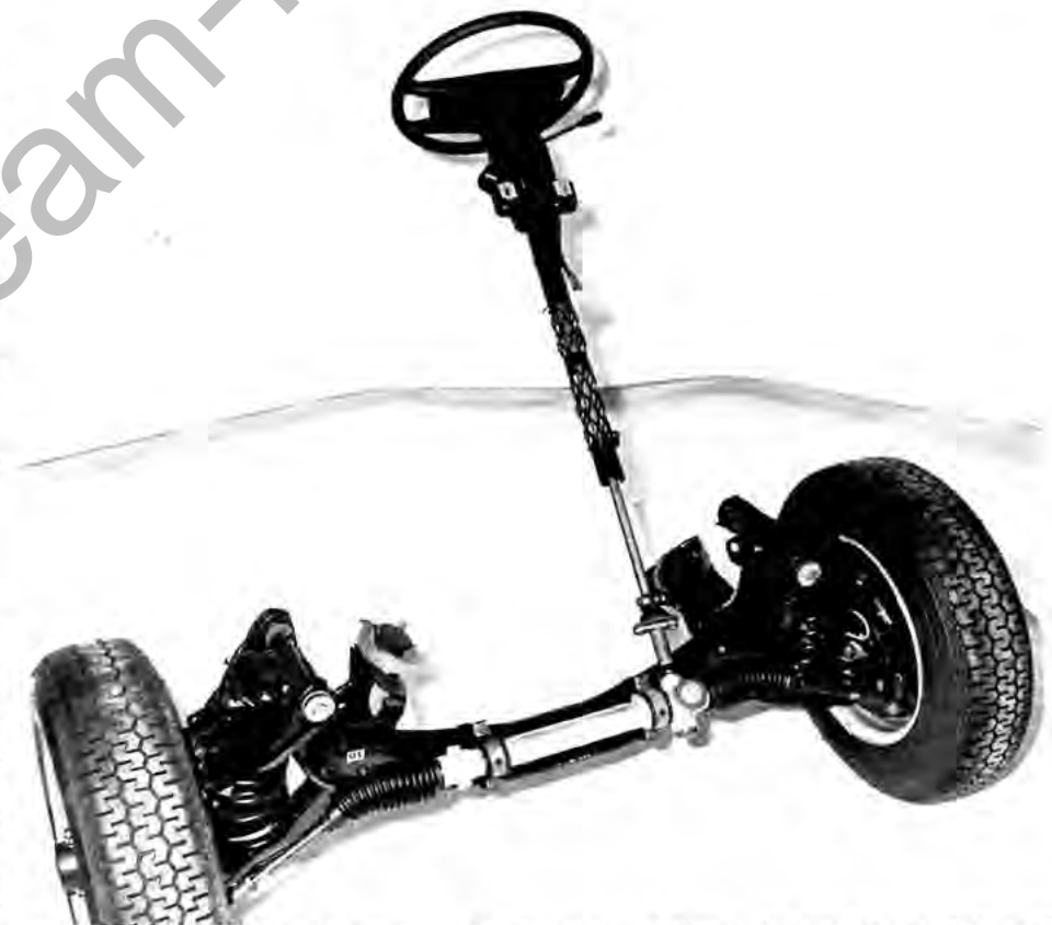
Abbildung 1: Kadett-Vorderachse mit Zahnstangenlenkung, Sicherheitslenksäule und 4-Speichen-Lenkrad.
