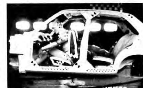
BILDER 5a – 5f: Dummies beim Versuch Frontalaufprall. Vorn mit, hinten ohne Gurt. Die Mithilfe dieser je 50.000,- DM teuren Testpuppen bei der Lösung der Sicherheitsprobleme im Straßenverkehr ist heutzutage aus der täglichen Entwicklungsarbeit nicht mehr wegzudenken.
