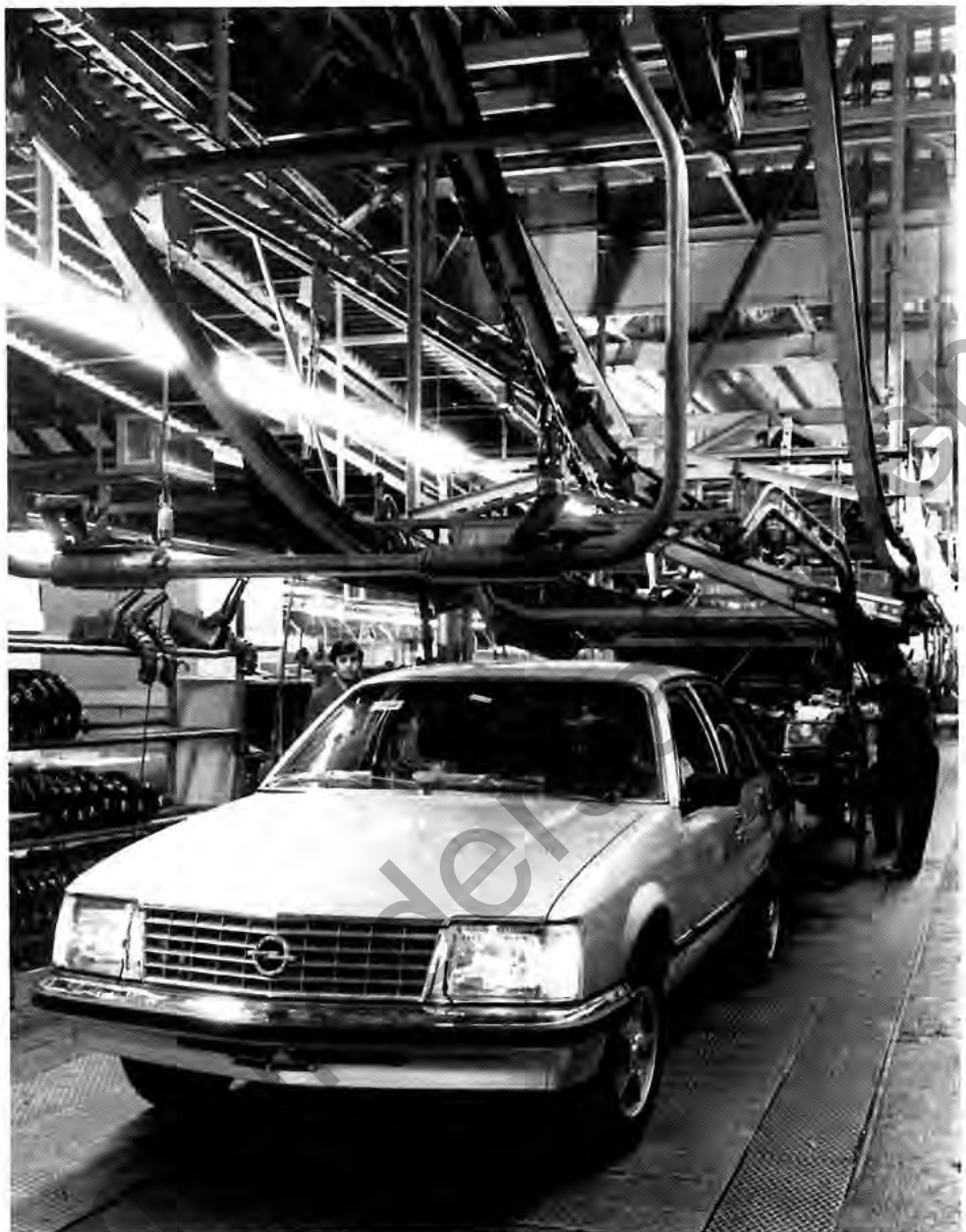
Die Produktion von SENATOR und MONZA im K 40 unseres Rüsselsheimer Werkes läuft seit Wochen auf vollen Touren. Der Schnappschuß wurde am Endmontageband an der Stelle gemacht, wo der Wagen das Band mit eigener Kraft verläßt.
