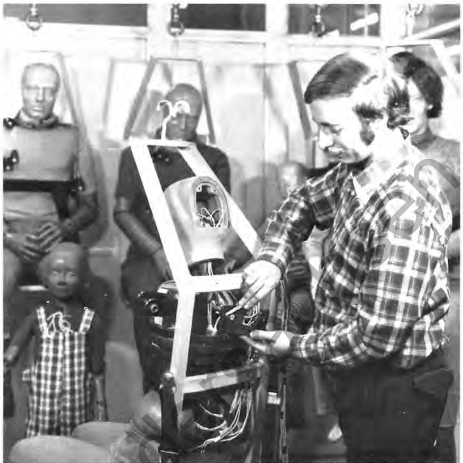
BILD 2: Das stählerne Innenleben eines Dummies. Mitarbeiter Georg Siebenhain überprüft die Beschleunigungssensoren.
