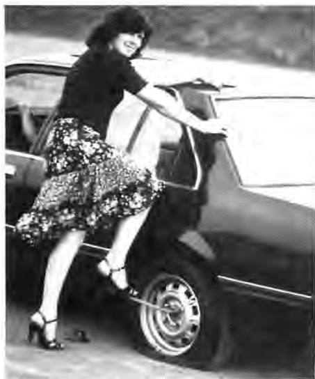
Abbildung 3: Mit einem Fuß auf das Hebelende stellen, und zwar links von der Radmutter.
