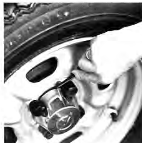
Abbildungen 1 und 2: Gezieltes Abheben von (je nach Modell) Radkappen oder Plastikdeckeln mit dem Schraubenzieher.
