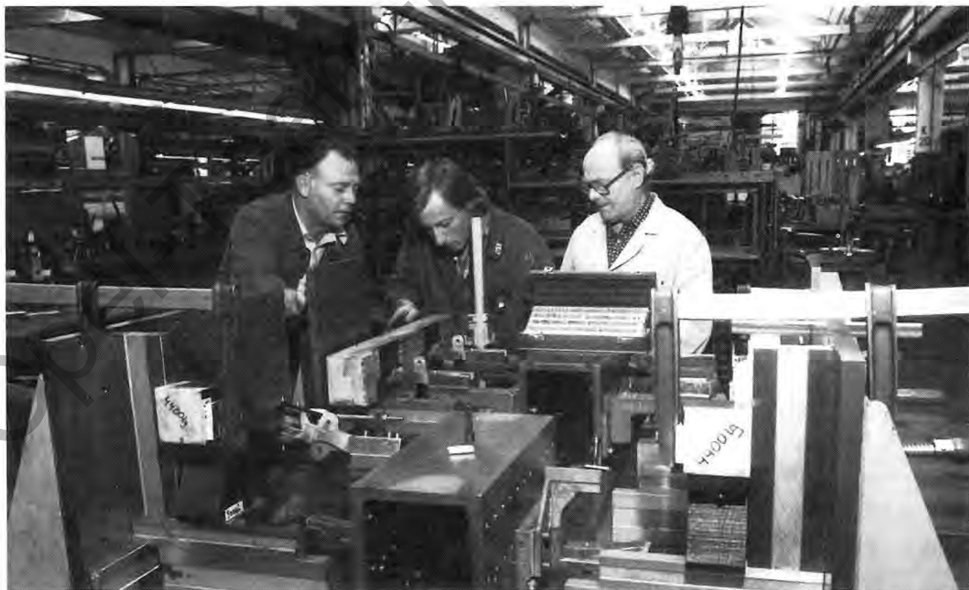
Vielpunktschweißwerkzeug mit Baulehre. Die Besprechungsgruppe zeigt Meister Erich Jochum sowie die Mitarbeiter Eugeny Seyda und Reinhard Dittenberger.
