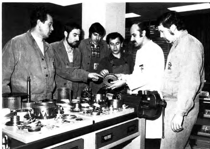
An der zerlegten Opel-Automatic lernen die Lehrgangsteilnehmer, auf dem Bild mit Fachtrainer Adam Weidlich, die einzelnen Bauteile kennen und ihren Zustand zu beurteilen.
