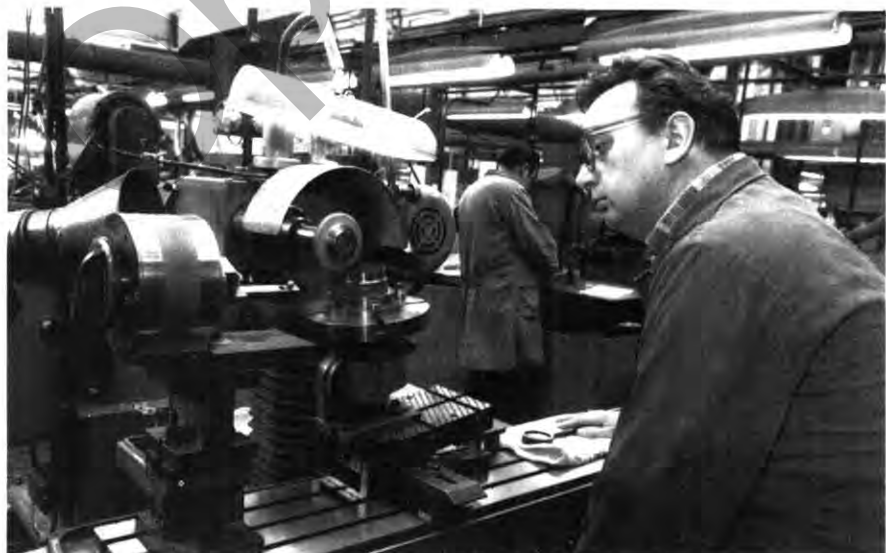
Mitarbeiter Manfred Fiebig an einer Universal-Schleifmaschine beim Schleifen von Spannaufnahmen für Synchronisiererringe. Genauigkeiten von \pm 0,002 mm und genaue Teilarbeit mit dem Teil-Apparat sind hier Voraussetzung.
