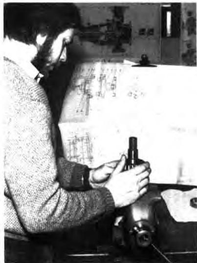
Seminar Teilnehmer H. Junker bei der Montage eines Kegelrollenlagers.
