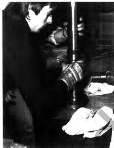
Seminar Teilnehmer W. Dechent beim Warmziehen eines Wälzlagers.
