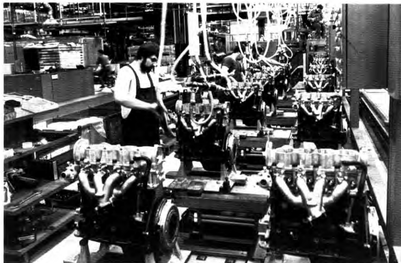
Automatische Transport- und Stapleinrichtungen sorgen im Motorenbau dafür, daß jedes benötigte Teil im richtigen Augenblick an der richtigen Stelle zur Verfügung steht. (Weitere Aufnahmen aus dem Motorenbau in der nächsten Ausgabe.)
