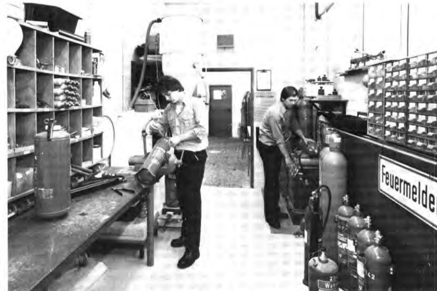
Die Mitarbeiter der Werkfeuerwehr E. Gmeinwieser und K. Rühl (von links) beim Prüfen und Füllen von Handfeuerlöschern.
