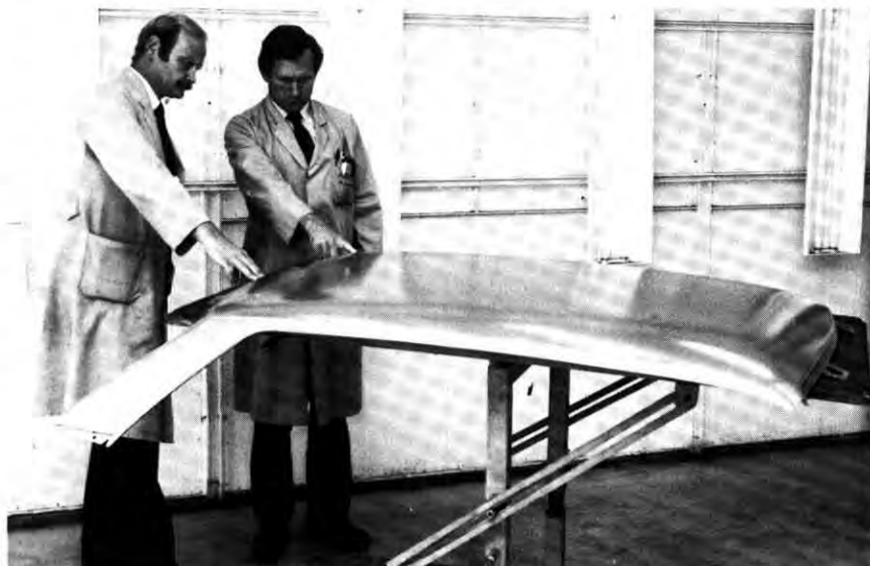
Hier überzeugen sich im Grünlicht-Raum Obermeister G. Armbrust und Meister A. Hecktor von der einwandfreien Herstellung des Ascona-Daches.
