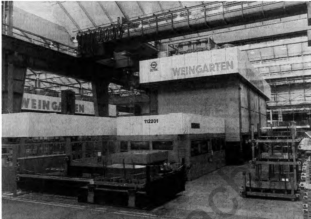
Groß-Transferpresse: Sieben dieser High-Tech-Maschinen produzieren täglich 100 000 Teile.
