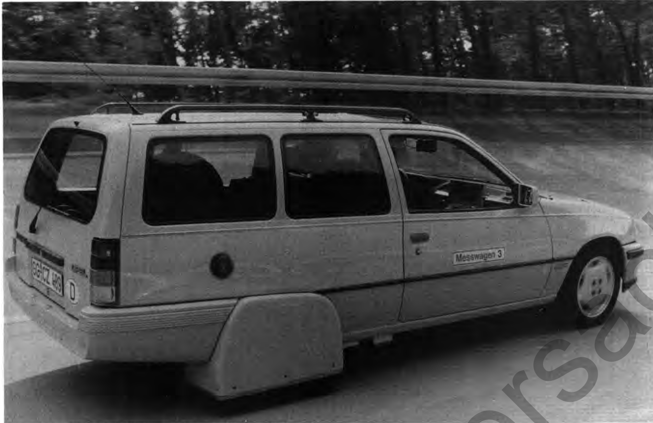
Spezialist: Dieser Kadett simuliert Rollwiderstände von Corsa bis Senator
