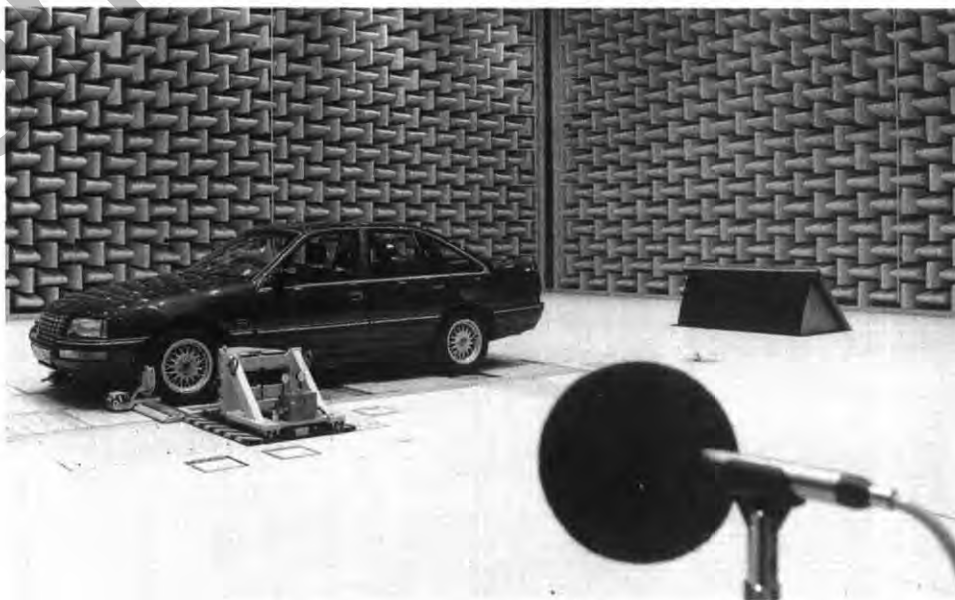
Lauschangriff: Unbestechliche Meßgeräte im Akustik-Prüfstand
