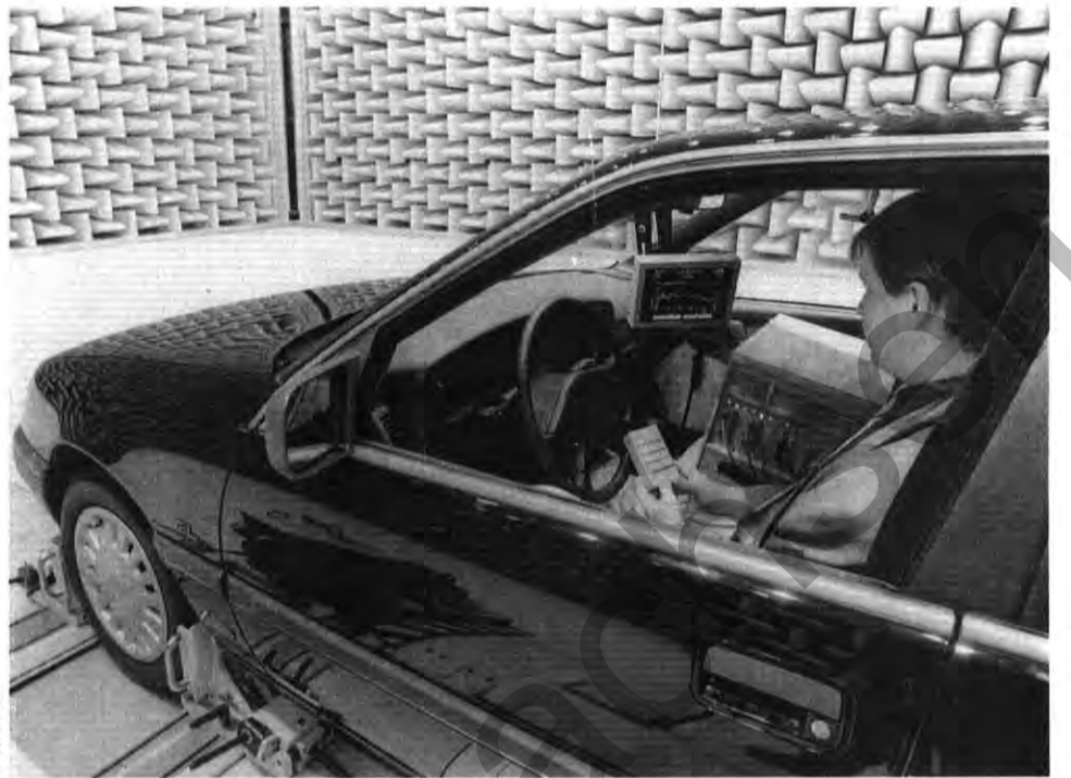
Meß-Verfahren: Fahrgeräusche werden im Stehen gemessen
