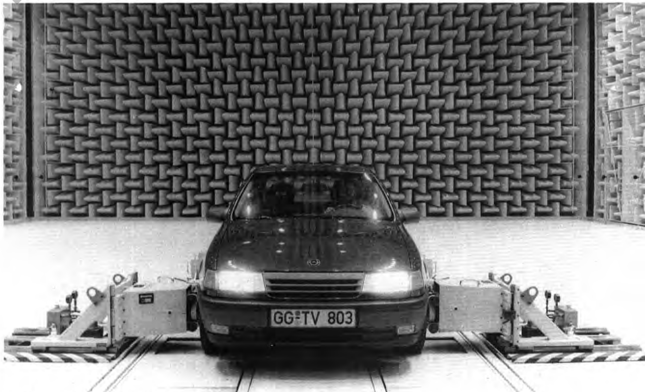
Meß-Labor: Der neue Schallmeßraum des Technischen Entwicklungszentrums
