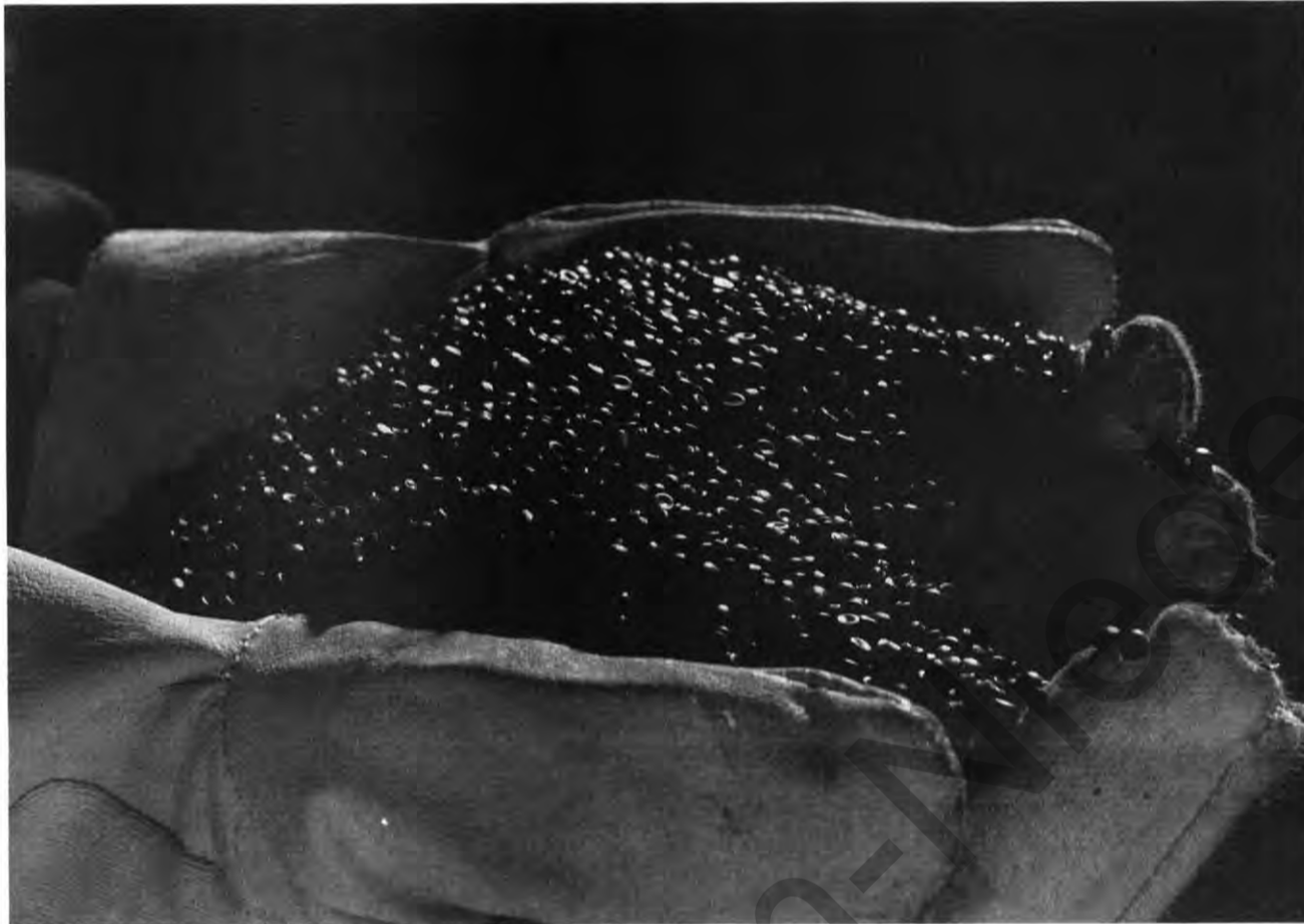
Granulat: Rohstoff aus zermahlenem Plastik für neue Autoteile
