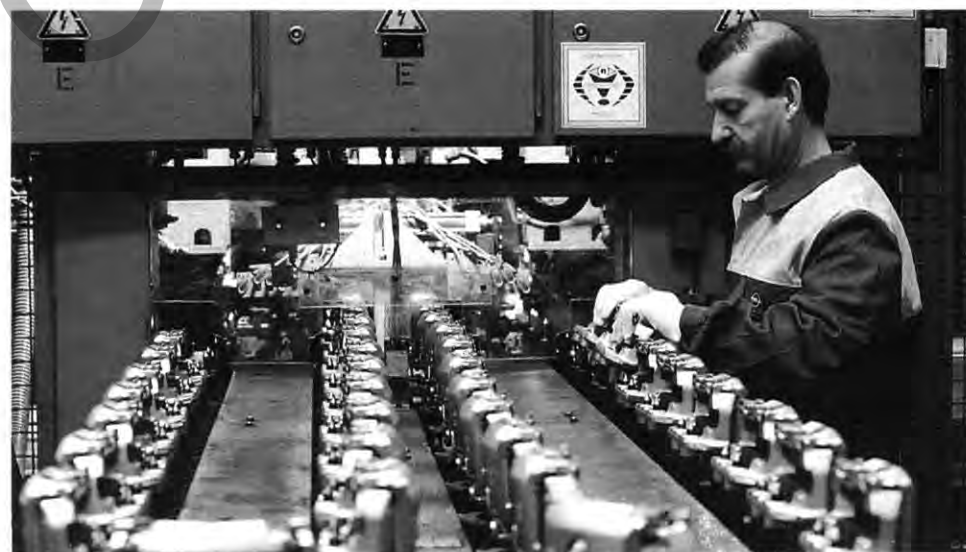
Federbeinmontage: Manuel Cruz bestückt die Maschine mit Bremssätteln
