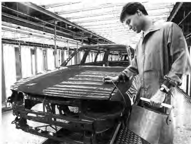
Kontrolle: Lackschicht im Speziallicht
