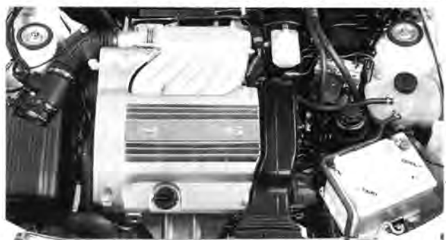
Motorraum: Sechs Zylinder in V-Form
