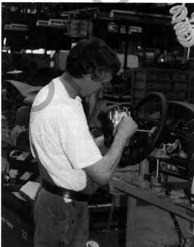
Sicherer Griff: Herbert Bente montiert ein Airbag-Modul
