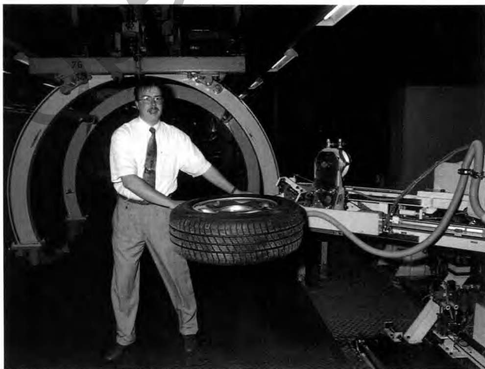
Rad-Schlag: Student Stefan Schikora mit dem Roboter zum Reserverad-Einlegen
