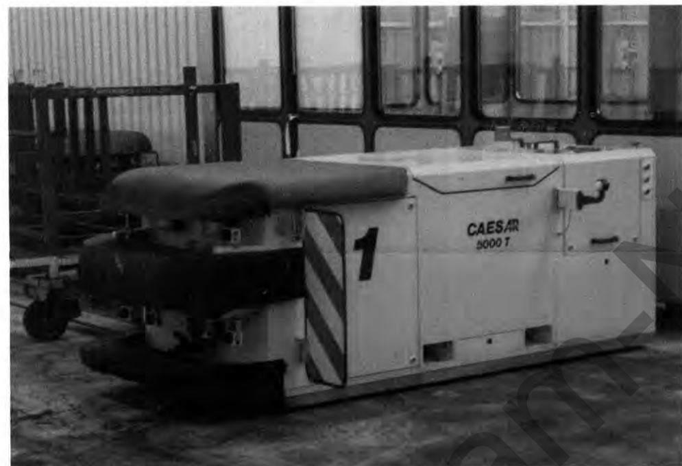
Vollautomatisch: Caesar übernimmt wichtige Transportaufgaben zwischen Preßwerk und Lager
