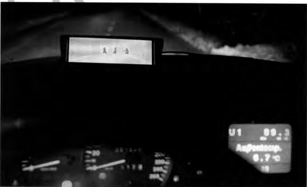
Das Multi-Info-Display im Omega versorgt den Fahrer mit allen wesentlichen Daten
