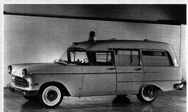
Kapitän von 1959: Den von Miesen erstellte Spezialaufbau kennzeichnet die erhöhte hintere Seitentür
