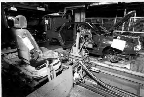
Früher mußten die schweren Sitze in die Fahrzeuge gehoben werden. Diese Arbeit erledigen bei Vectra und Calibra jetzt Automaten. Beim neuen Omega werden die Vordersitze von zwei Mitarbeitern mittels unterstützender Hebevorrichtungen eingesetzt. Auch hier wird eine vollautomatische Lösung angestrebt.
