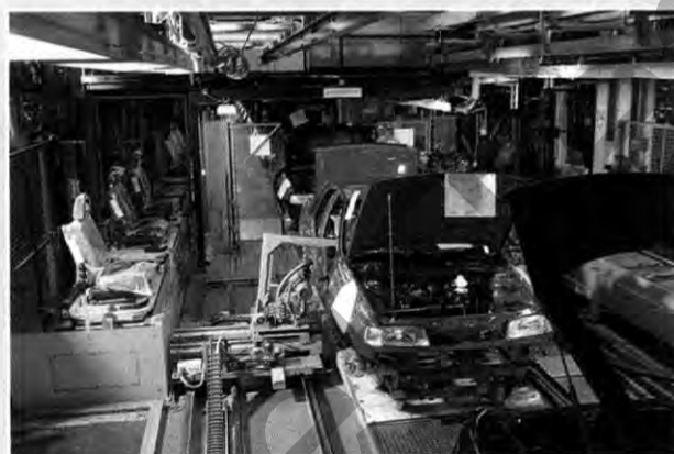
Ein Greifer schließt sich um den Sitz und hebt ihn von der Palette. Dann gleitet er über eine Führungsschiene nach vorne, neigt den Sitz etwas und setzt ihn durch die Türöffnung auf dem Boden der Karosserie ab. Die ganze Aktion dauert nur 50 Sekunden. Verschraubt werden die Sitze anschließend per Hand.
