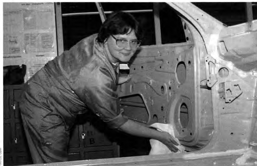
Vielseitiges Arbeiten: Regina Schaub versiegelt Nähte an einem Corsa
