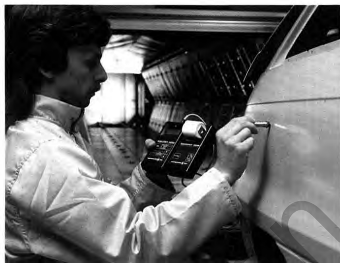
ah Kontrollpunkt: Nach dem Lackiervorgang wird die Schichtdicke geprüft
