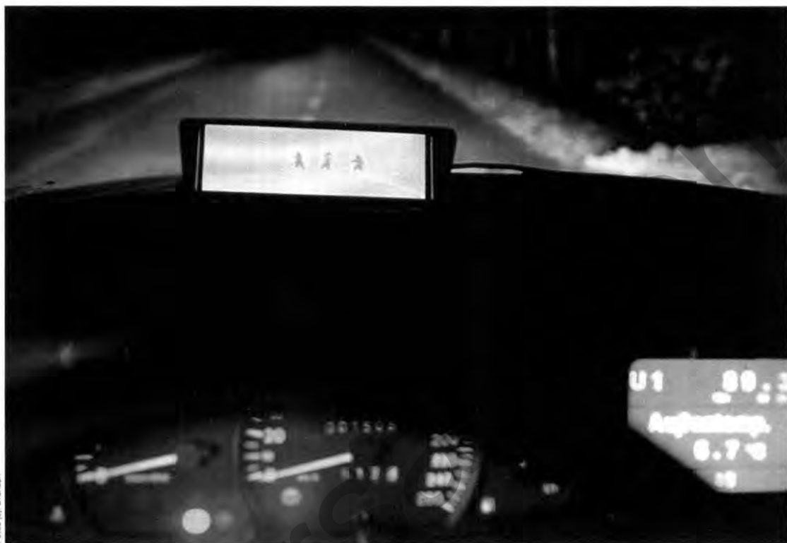
Bringt Licht ins Dunkel: Nachtsichtgerät erhöht Sicherheit
