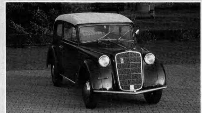
Klein und knuffig: Der Olympia von 1935 bot als erstes Automobil eine selbsttragende Karosserie mit einem Blechgerippe
