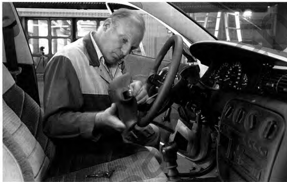
Mit Sicherheit Qualität: Wie hier bei der Airbag-Montage muß in allen Bereichen jeder Handgriff sitzen
