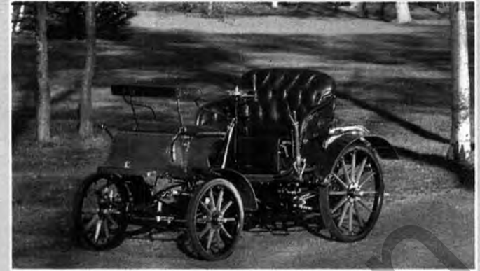
Lutzmann statt Fahrrad: 1899 nimmt Opel die Produktion von Autos auf. Der Lutzmann leistet 3,5 PS aus 1,5 Liter Hubraum
