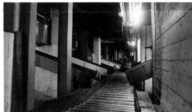
Förderband: Blechreste gelangen zurück in die Produktion
