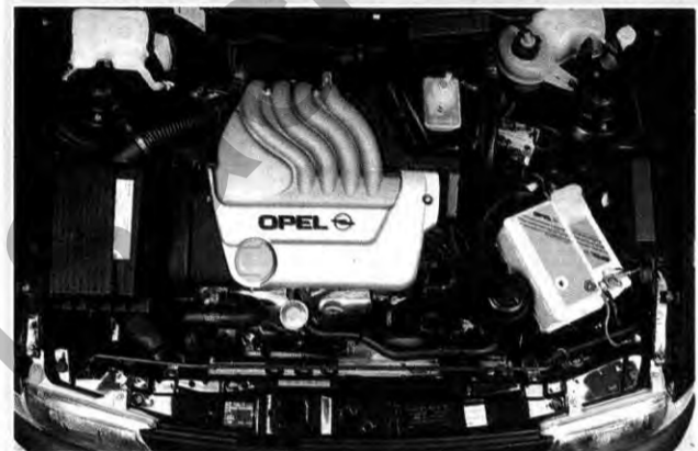
Kopf-Arbeit: Im 1,6-Liter-Ecotec arbeiten 16 Ventile
