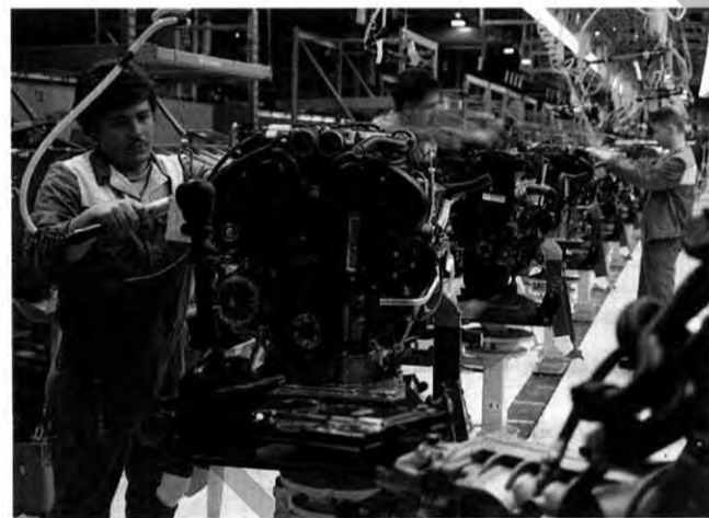
„Dress-Up“: Isa Dönmetz verlegt ein Lichtmaschinenkabel an einem Omega-Triebwerk. Im Hintergrund: Horst Nedecki und Raimund Hirsch beim Aufrüsten.
