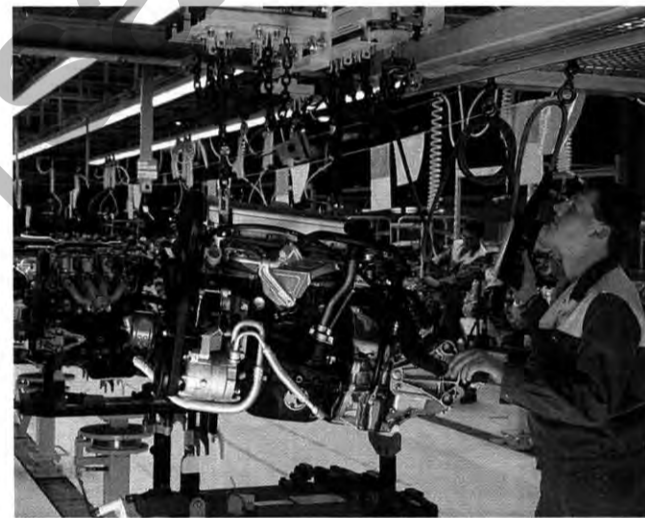
K 40, Motoren-Endaufrüstung Linie I: Michael Stroh fährt einen Vectra-Motor per Seilzug nach oben für den Weitertransport zur nächsten Arbeitsstation. Das Motor-Aufnahme-Gehänge paßt für alle Motoren dieser Fahrzeug-Linie. Für jeden Typ gibt es speziell drei farblich markierte Haken, an denen er aufgehängt wird.
