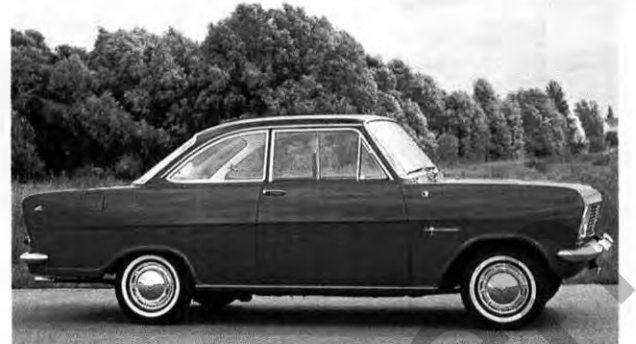
Die Basis für sportliche Erfolge: Das Kadett-A-Coupé von 1963. Der Motor leistet 48 PS bei 5 400 Umdrehungen und beschleunigt den kleinen Flitzer auf 136 km/h
