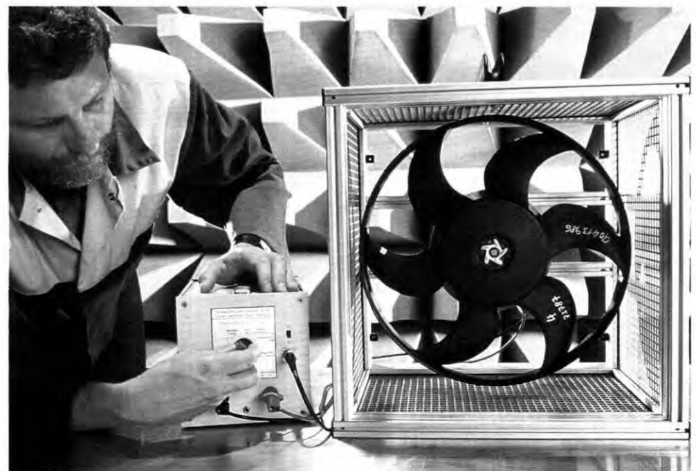
...und mißt die Funkentstörung an einem Kühlergebläse
