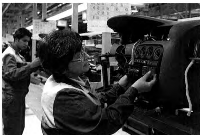
Gehört zum guten Ton: Melitta Roth installiert bei der Cockpit-Vormontage ein Radio.
