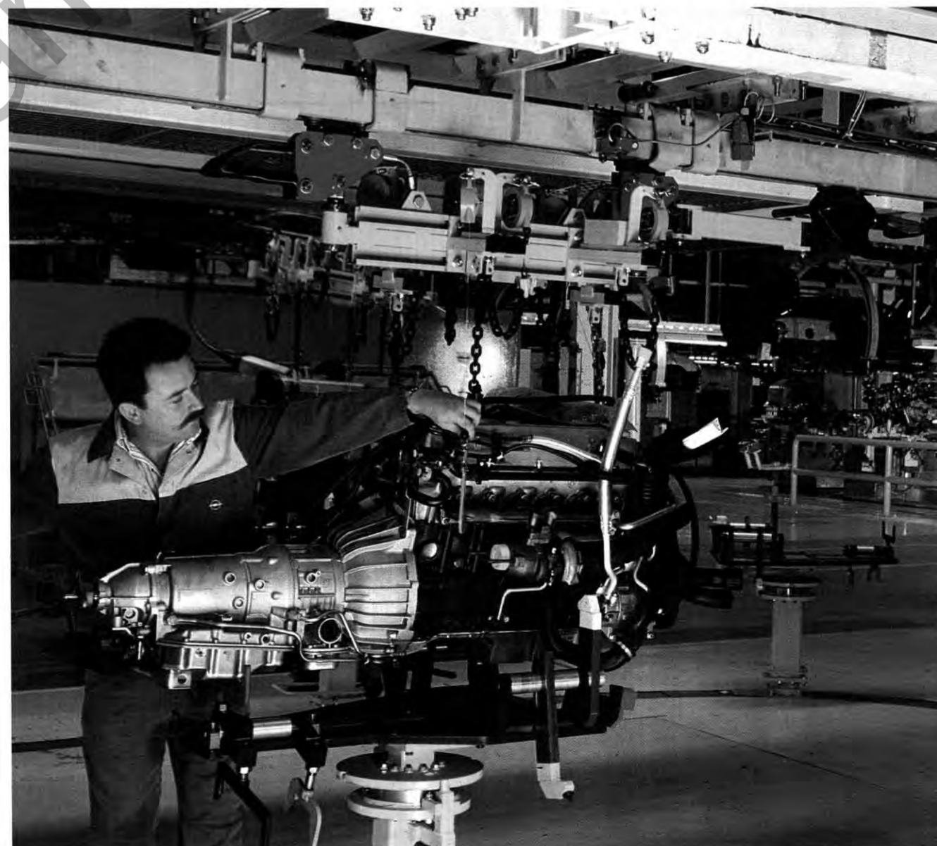
Himmelfahrt: Andreas Recker hakt einen V6 mit Automatikgetriebe ins Universalgehänge ein. Gleich geht's ab nach oben.
