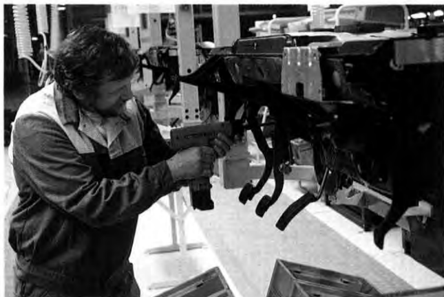
Trittfest: Josef Kozik beim Pedaleinbau am Cockpit-Grundträger Omega.
