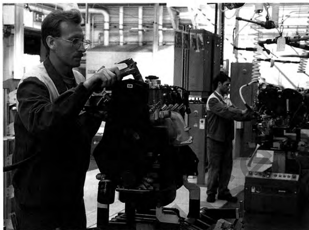
Abfüllung: Waldemar Ptasznik versorgt an der Motor-Vorausrüstungs-Linie I einen Vectra-Motor mit Öl. Die Triebwerke sitzen auf
