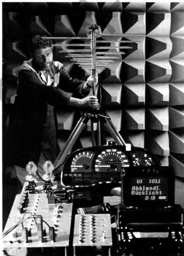
Klaus Dammel prüft die Einstrahlfestigkeit einer Komponente...
