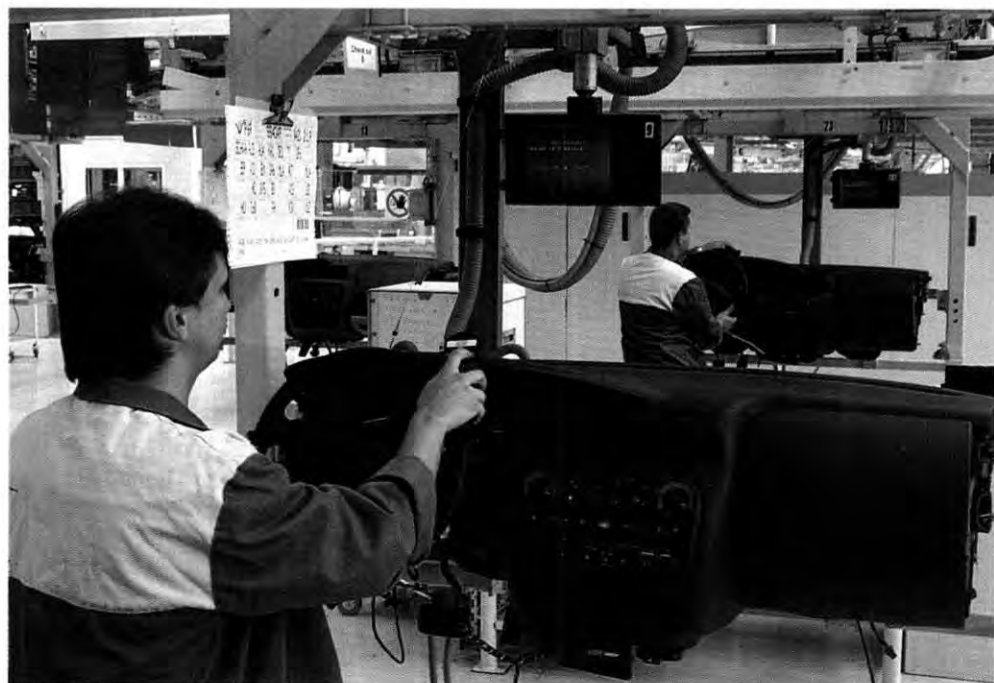
Check Out: Test sämtlicher elektronischer Cockpit-Funktionen mit dem Computer. Marek Latko und Christopher Mayer steuern
