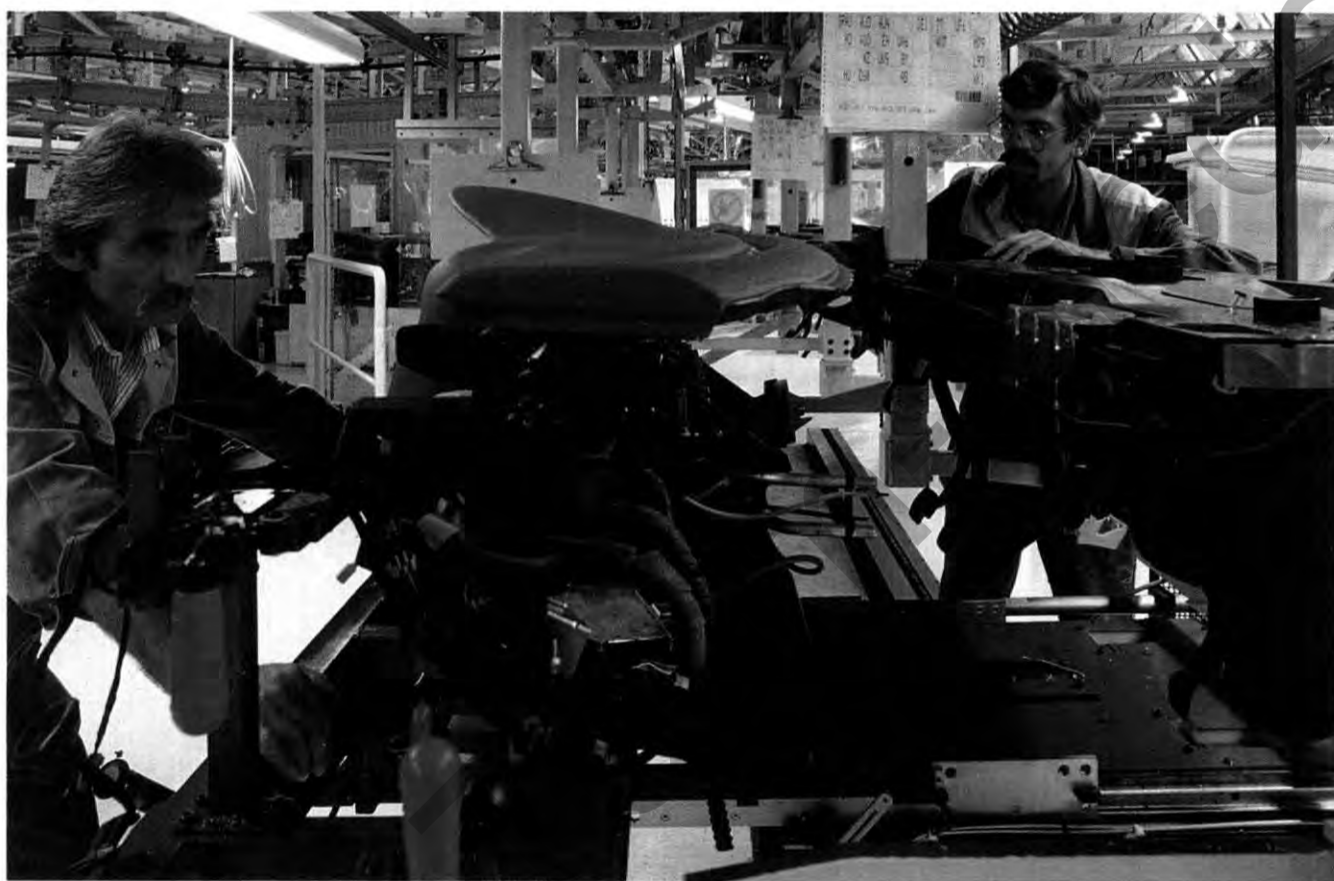
„Kleine Hochzeit“: Herrmann Radke und Kurt Lappat verheiraten Armaturentafel und Grundträger zu einem dauerhaften
